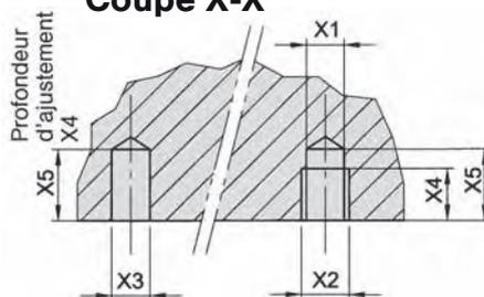
\* = Filetage uniquement dans le vérin Ø 32 mm (profondeur de pas 9 mm).
