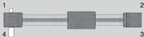
Arbre pour raccordement d'encodeur et synchronisation
