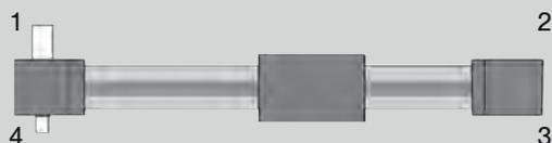
Arbre pour raccordement d'encodeur et synchronisation
