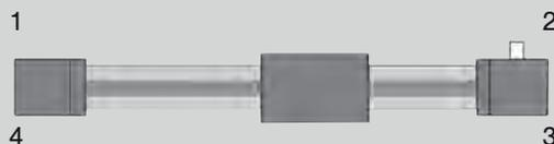
Arbre pour raccordement d'encodeur en 2
