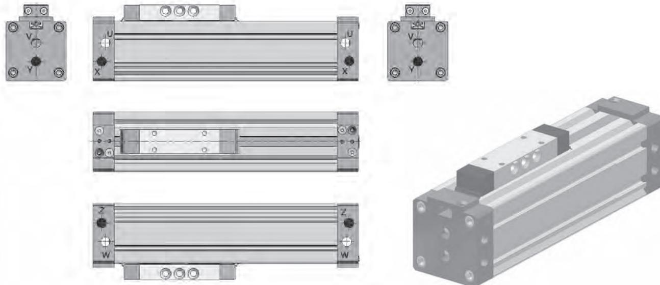
Utiliser le type -04 pour la connexion d'air frontale aux deux têtes ou la connexion frontale à une tête et latérale à la deuxième tête. Pour une connexion d'air unilatérale, une tête du vérin porte 6 raccords alors que l'autre en est dépourvue. Les raccords U-V-W en liaison mutuelle servent au déplacement dans un sens, les raccords X-Y-Z au déplacement dans l'autre sens. Les dimensions des raccords sont identiques à celles du type -02.
