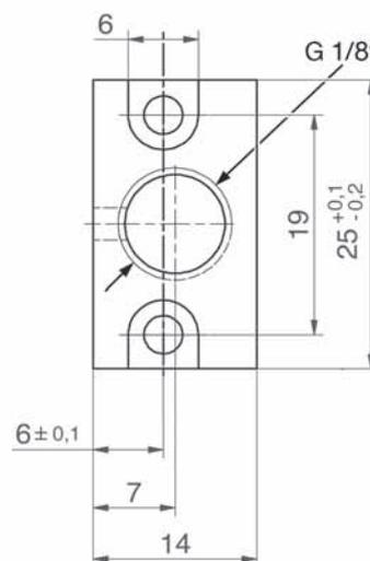
Adaptateur pour vacuostats de la série d'éjecteurs HV-SAVP/PV
