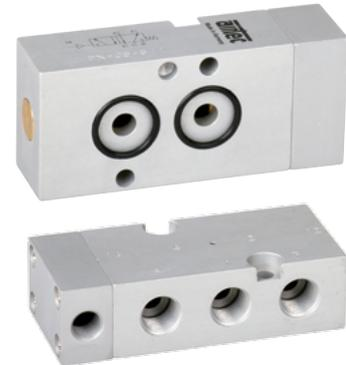
Distributeur à piston à commande pneumatique. L'application d'une pression permet d'inverser le sens de la vanne. Les vis de fixation, la broche de détrompage et les joints toriques font partie de la livraison.
