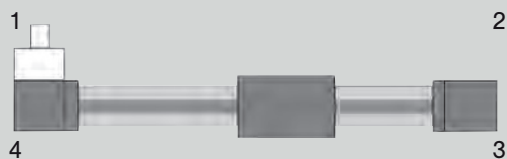
Frein en 1 avec arbre rallongé pour synchronisation en 1 Option: D1 (BR-253-1, BR-403-1)
