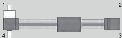
Frein en 1 avec arbre traversant pour la synchronisation Option: C1 (BR-252-1, BR-402-1)
