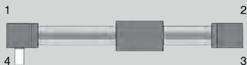
Arbre pour synchronisation en 4 Option: F4 (ZK-254-4 \varnothing 25, ZK-404-4 \varnothing 40)
