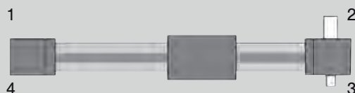
Arbre pour raccordement d'encodeur et synchronisation Option: H2 (ZK-256-2 \varnothing 25, ZK-406-2 \varnothing 40)
