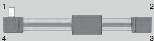
Arbre pour synchronisation en 1 Option: F1 (ZK-254-1 \varnothing 25, ZK-404-1 \varnothing 40)
