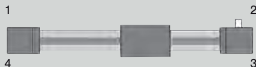
Arbre pour raccordement d'encodeur en 2 Option: G2 (ZK-255-2 \varnothing 25, ZK-405-2 \varnothing 40)
