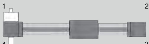
Frein en 1 avec arbre rallongé pour synchronisation en 4 Option: B1 (BR-251-1, BR-401-1)
